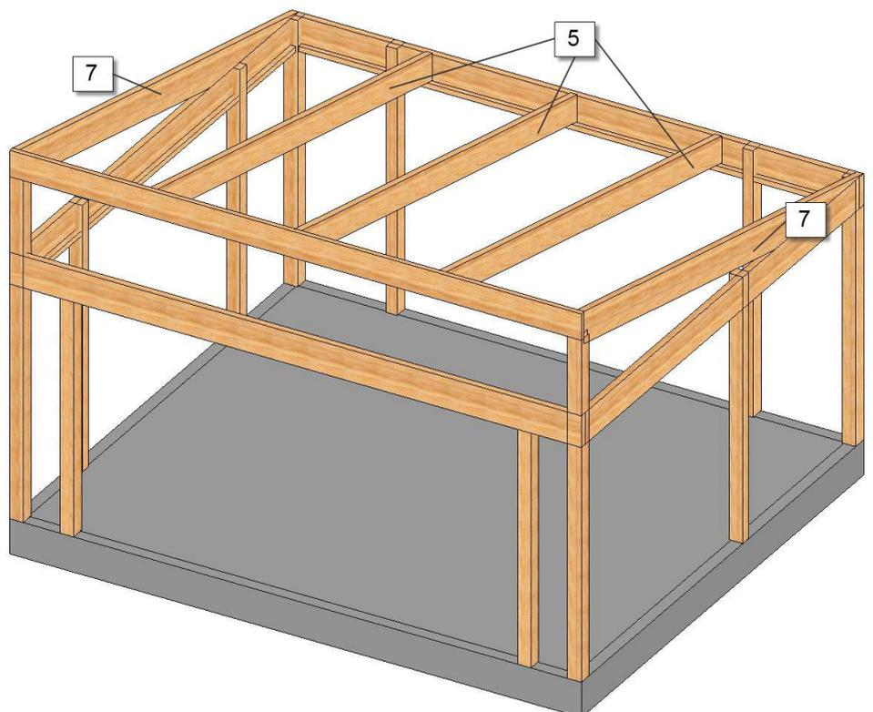
**5.** Skru fast kubbingen (12) mot overkant av den bakre bærebjelken som en forlengning av midttakbjelkene. Denne skal både skrues og limes. Lim medfølger ikke!
