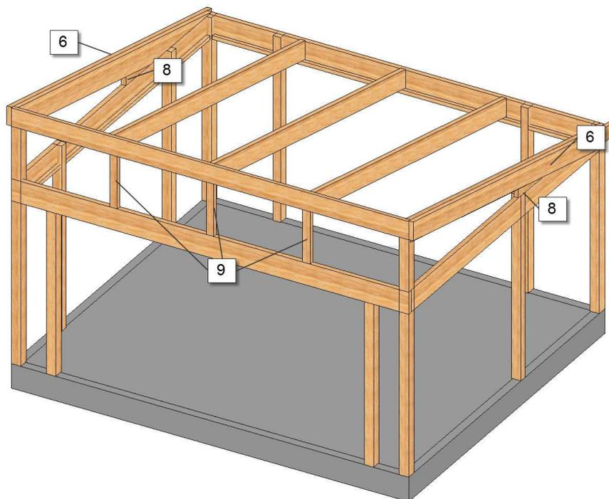
**6.** Montieren Sie danach die Giebelsparren (6). Diese werden direkt außen an die Giebelkeilen festgeschraubt. Folgen Sie der Oberkante des Riegels(12) und der vorderen Querpfette
