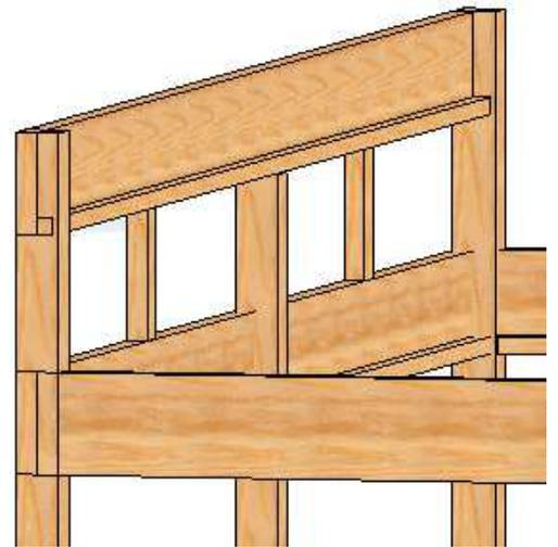
**4.** Monter gavlkilerne (7) oven på sidebjælkerne og mod de forreste stolper. De fastgøres i stolperne og sidebjælkerne. NB! Gavlkilen er ingen tagbjælke, og der må ikke monteres tagprofil på den! Fortsæt derefter med de midterste tagbjælker (5). Fordel dem iht. c/c-mål fra din tegning. Udskæringen i de midterste tagbjælker placeres i de monterede planker på bjælkerne.
