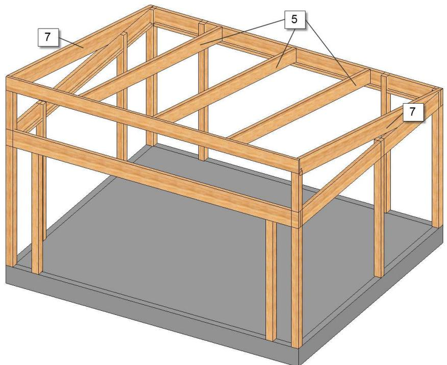
**5.** Skruva fast tassregeln(12) i ovankanten av den bakre bärlinan som en förlängning av mittakbalkarna. Denna skall både skruvas och limmas.
