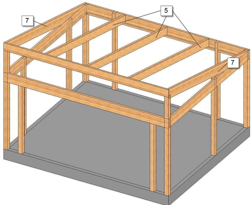
5. Ruuvaa kiinni kattotukipuut (12) takimmaisena tukiparrun yläpuolelle keskikattopalkkien jatkeeksi. Ne tulee sekä ruuvata että liimata. Liima ei sisälly! Ruuvaa kiinni katonrajan lauta.
