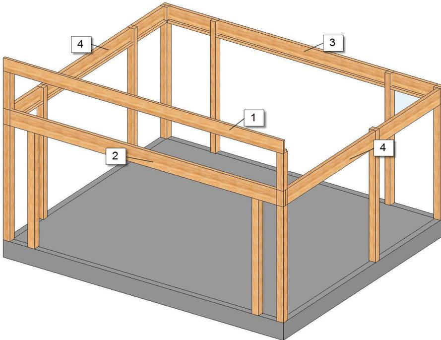
**3.** Leimen und schrauben Sie die 45x45-Leiste (10) an der Unterkante der vorderen Querpfetten-Innenseite sowie an den beiden Seitenbalken fest. Auf der hinteren Querpfette montieren Sie die 45x70-Leiste (11).
