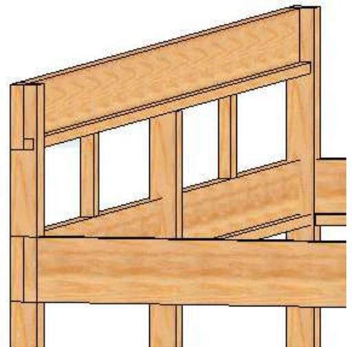
**3.** Lim og skru fast en 45x45 mm bjelke (10) i underkant på innsiden av den fremre bærebjelken samt på begge sidebjelkene. På den bakre bærebjelken monterer du en 45x70 mm bjelke (11). Lim medfølger ikke.
