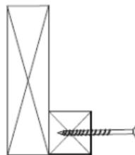
**4.** Monter gavlkilene (7) oppå sidebjelkene og mot de fremre stolpene. Disse festes i stolpene og sidebjelkene. OBS! Gavlkilen er ingen takbjelke, så på den skal det ikke monteres noen takprofil! Fortsett deretter med midttakbjelkene (5). Fordel disse i henhold til c/c-målet fra tegningen din. Utsparingene i midttakbjelkene plasseres i de monterte bjelkene på bærebjelkene.
