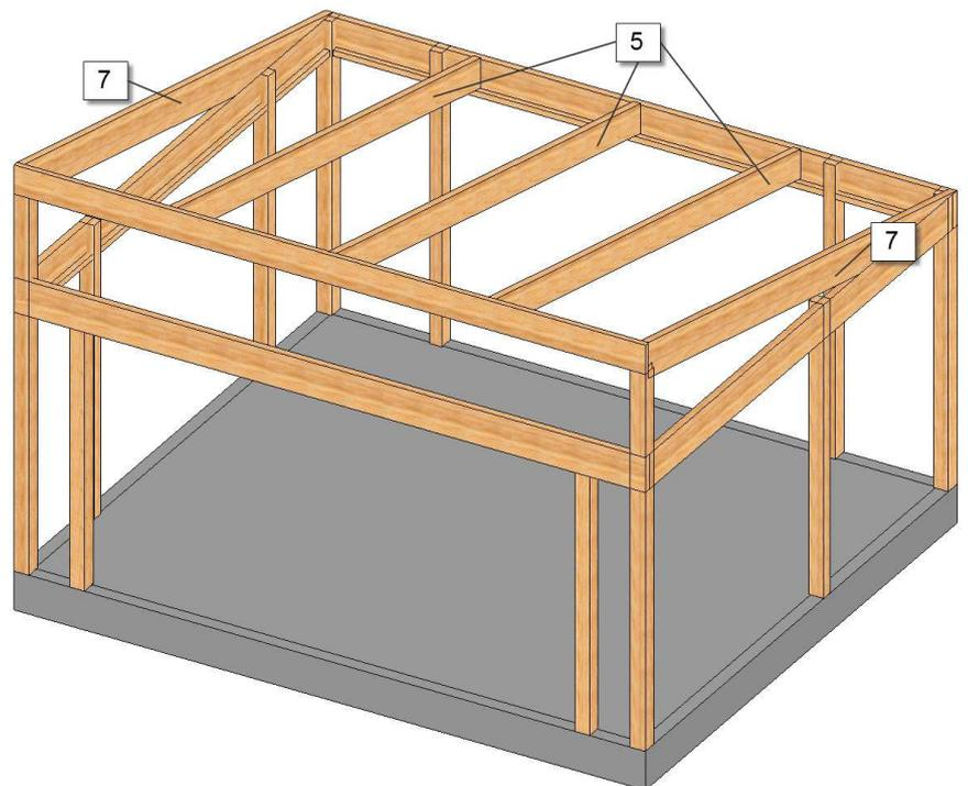
**5.** Schrauben Sie den Riegel (12) an der Oberkante der hinteren Querpfette als Verlängerung der mittleren Sparren fest. Diese müssen sowohl fest geschraubt als auch geleimt werden.
