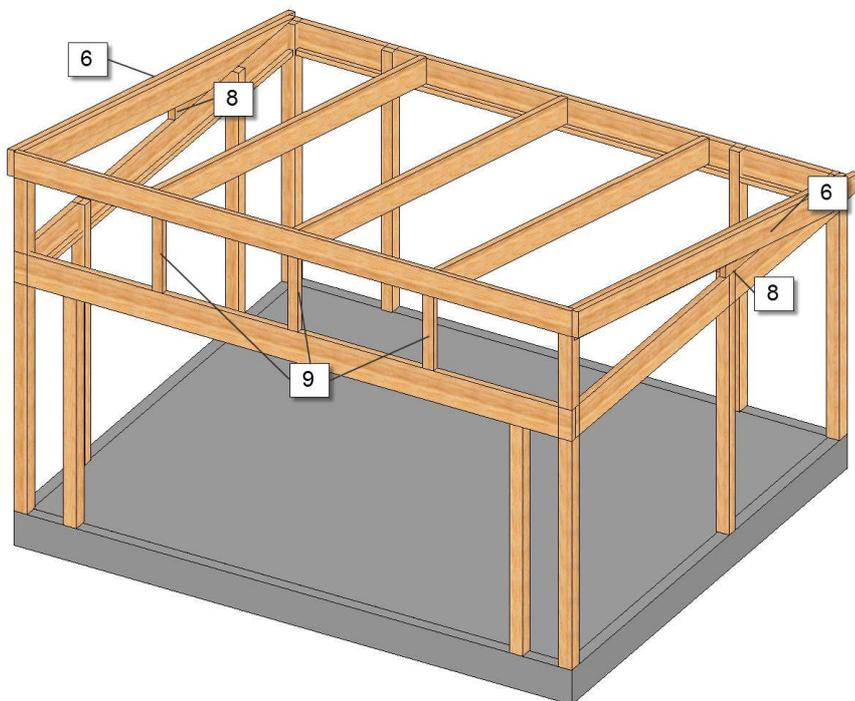
**6.** Montera därefter fast gaveltakbalkarna(6). Dessa skruvas fast direkt utanpå gavelkilarna. Följ ovankanten av tassregeln och den främre bärlinan.
