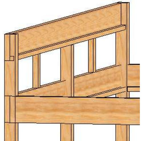
**4.** Montieren Sie die Giebelkeilen (7) oberhalb der Seitenbalken und an den vorderen Pfosten fest. Diese werden an den Pfosten und den Seitenbalken befestigt. **ACHTUNG!** Giebelkeile sind keine Sparren und es sollte kein Dachprofil auf ihnen montiert werden! Fahren Sie danach mit den mittleren Sparren (5) fort. Verteilen Sie diese laut Mittenabstand-Maß von Ihrer Zeichnung. Die Aussparung der mittleren Sparren wird auf die montierten Leisten der Querpfetten gesetzt.
