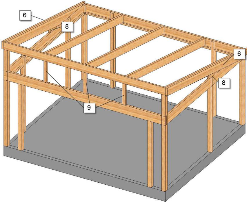
**6.** Asenna sen jälkeen päätykattopalkit (6). Ne ruuvataan suoraan päätykiilojen ulkopuolelle. Seuraa kattotukipuiden yläpuolta ja etummaista tukiparrua.
