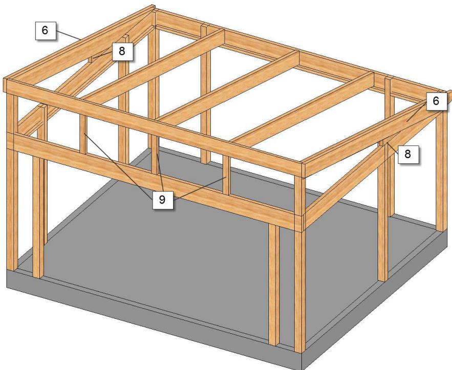
**6.** Monter derefter gavlens tagbjælker (6). De skrues fast direkte uden på gavlkilerne. Følg overkanten af udhængsbjælken og den forreste bjælke.
